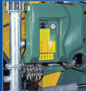
Quadro comando per macchina idraulica
