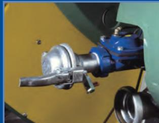
**Valvola di scarico a membrana per arresto in depressione**
