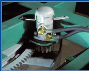
**Dispositivo idraulico per la rotazione della torretta**
