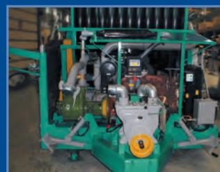
**Motopompa incorporata alla struttura della macchina**
