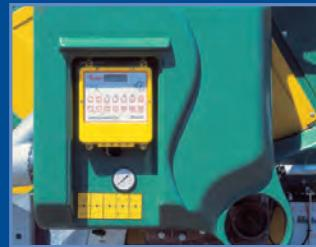
**Programmatore per la regolazione della velocità di riavvolgimento**
