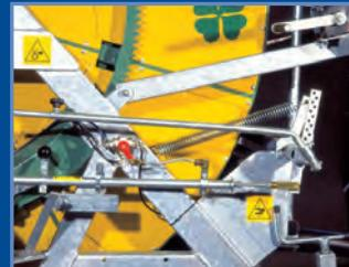
**Dispositivo di azionamento delle valvole di arresto**
