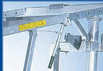
Leva per l'azionamento a distanza del perno di arresto della torretta girevole.
