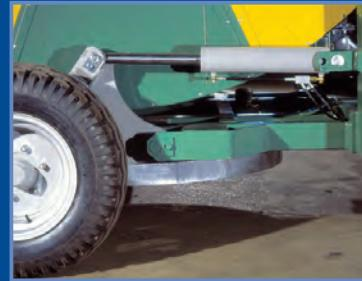
Dettaglio ralla e cilindro idraulico
